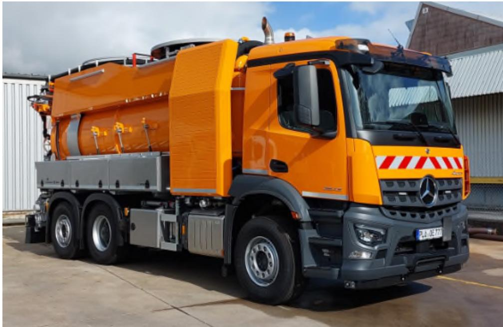
Alle vier Autos sind mit orangenen Rundumleuchten ausgestattet. Durch Lackier- und Beklebung wird zusätzlicher Schutz im Straßenverkehr geboten.
