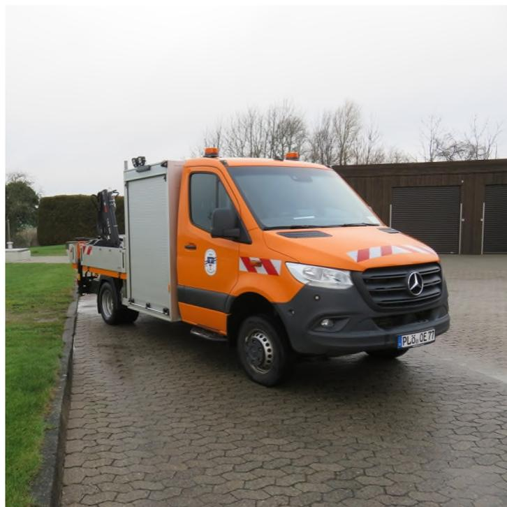
Für diverse Reinigungsarbeiten des Kanalsystems, der Pumpstationen, sowie auf der Kläranlage selbst, steht uns ein Saug- und Spülwagen zur Verfügung. Bei Störungen, wie unter anderem Rohrbrüche oder Verstopfungen im Kanal, können auch noch weitere Aufgaben seinerseits dazu gezählt werden, wie z.B. Wasserhaltung.
